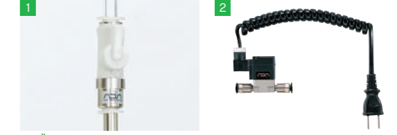
1 Öffnen und Schließen Sie das Kugelventil und Handventil jeden Morgen und Abend manuell. 2 Das Magnetventil ermöglicht ein automatisches Ein- und Ausschalten in Verbindung mit einem handelsüblichen Timer.
